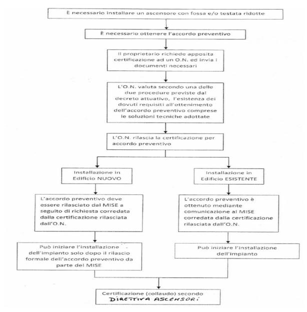
Lo schema sopra riportato oltre a specificare la procedura da tenere per l'ottenimento dell'accordo preventivo mostra l'iter nei vari casi possibili (installazione in Edificio Nuovo o Edificio Esistente) e le relative competenze.
